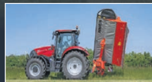
Repliable à 126° pendant le transport pour un confort optimal de l'opérateur.
